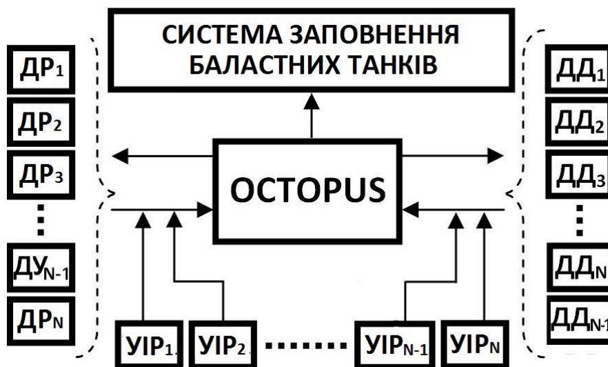
Рис. 10. Принципова схема інтеграції системи OCTOPUS з розробленою системою руйнування паразитних обсягів повітря; ДР – датчик рівня; ДД – датчик деформації; УІР – ультразвуковий індикатор рівня
