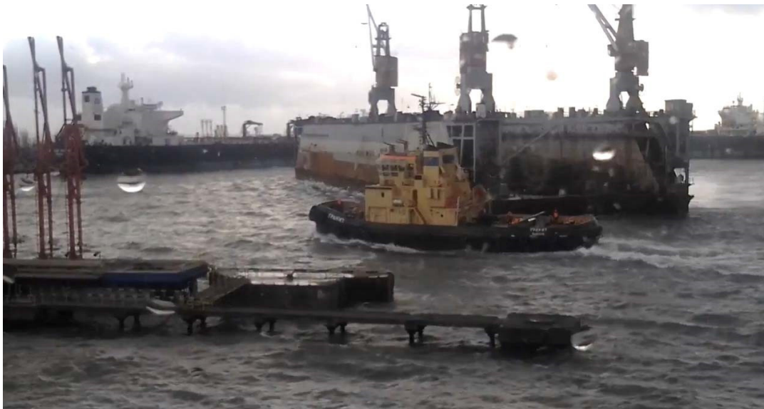
Рис. 7 – Рух плавдоку з усталеною швидкістю при дрейфі, який випереджує буксир «Граніт» на тлі пришвартованого танкера
