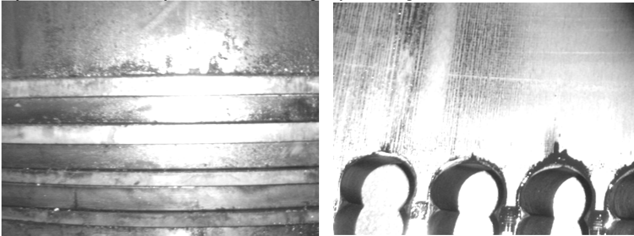
Рис.27. Стан деталей ЦПГ № 3 (експериментальний) наприкінці випробувань
