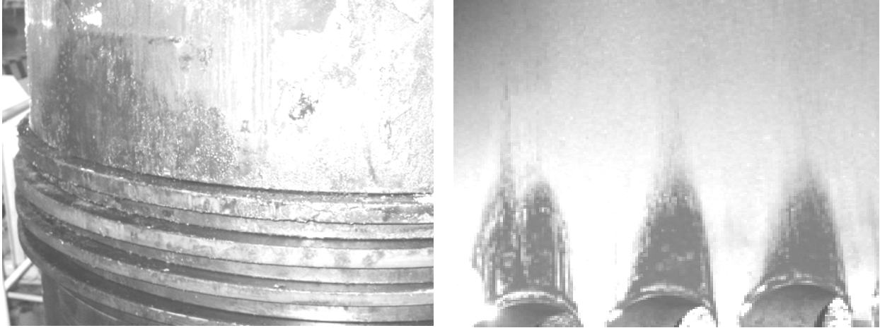
Рис.26. Стан деталей ЦПГ № 1 (базовий) наприкінці випробувань
