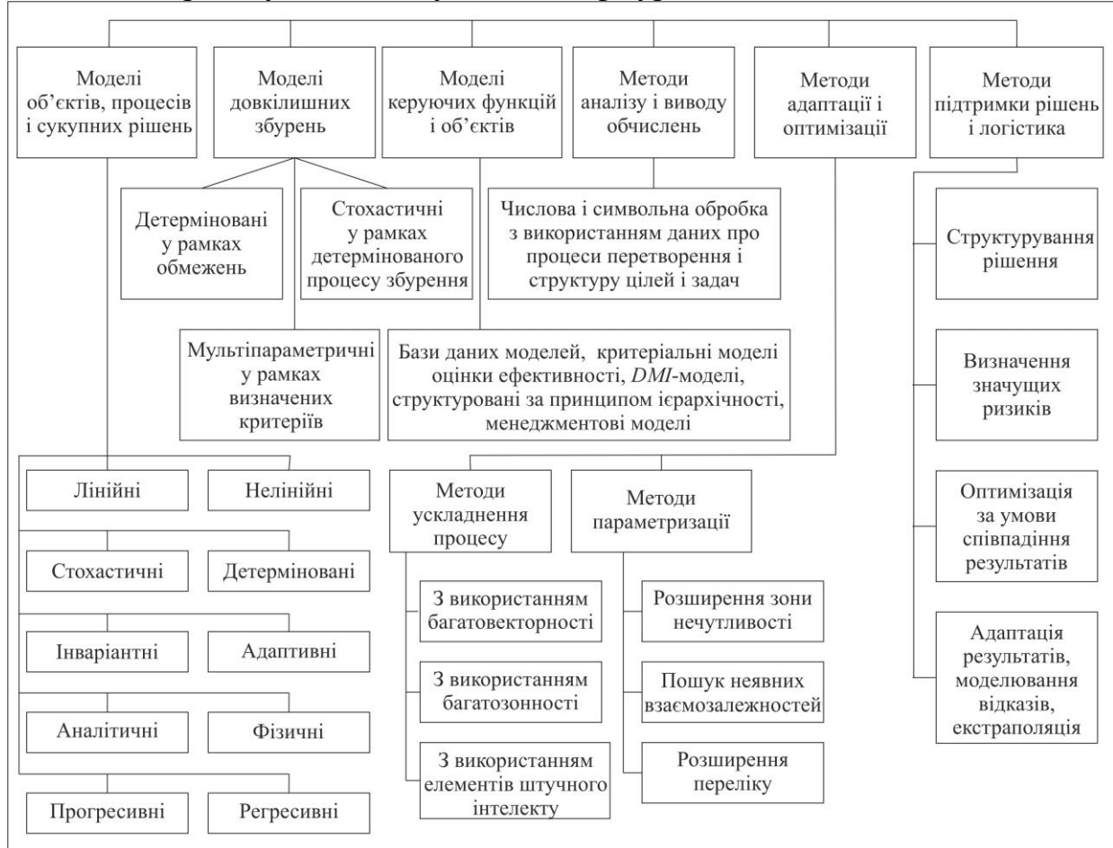
Рис. 8 Структура СППР при проектуванні та дослідженні СЕУ КПК
