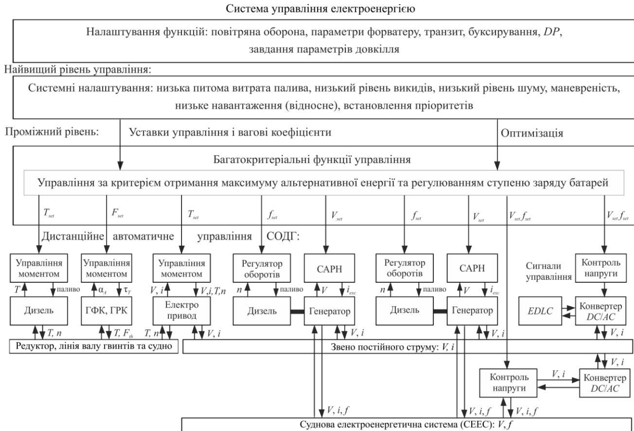
Рис. 5 Блок-схема стратегії управління СЕУ КПК за критерієм максимуму альтернативної енергії та регулювання ступеню заряду батарей СНЕ: САРН – система автоматичного регулювання напруги; X_{set} – уставка; T – упор; F – сила поштовху гвинта; f – частота напруги; V – напруга; n – частота обертання СОДГ; i_{exc} – струм збудження; i – струм; \tau_T – результуюча проекції вектору зусилля на площину руху; \alpha_A – кут повороту ПП відносно діаметральної площини судна В.О.
