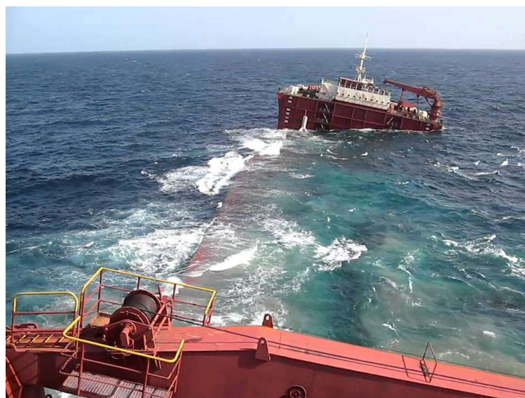
Рисунок 2.1 – Втрата остійності судном “MV Transporter” [96].
