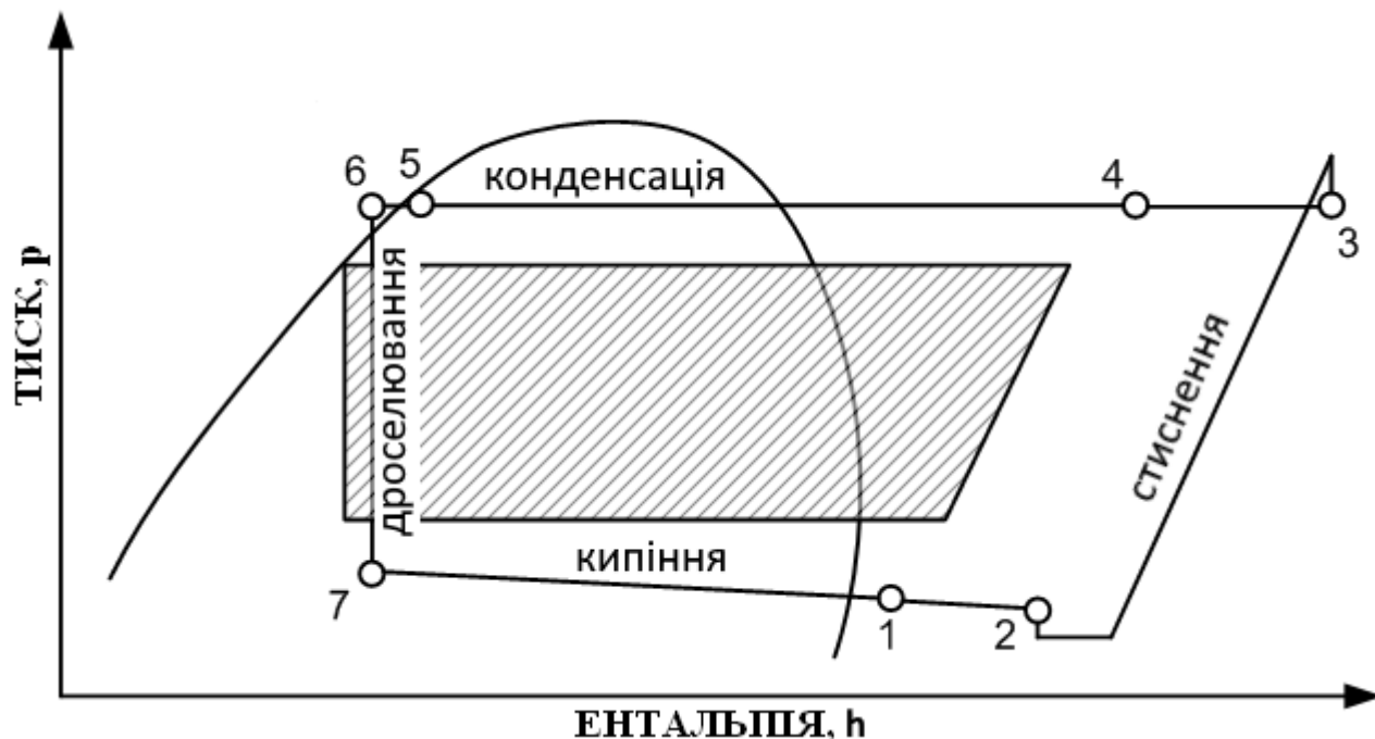
Рис. 3.3 – Дійсний холодильний цикл СХУ
