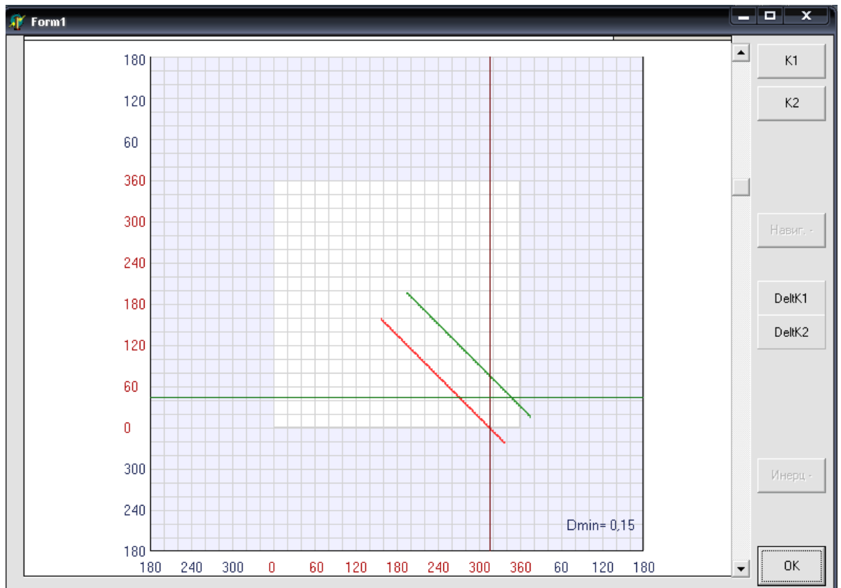
Рис. 5.11. Область небезпечних курсів без урахування інерційності суден ( V_2 = V_1 )
