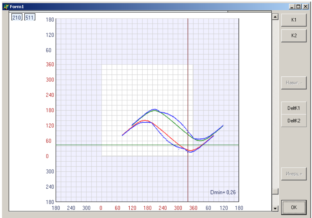
5.18. Область небезпечних курсів з урахуванням інерційності суден ( V_2 < V_1 )
