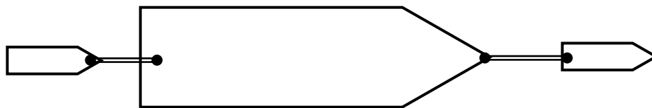
Рисунок 4.9. Ордер проводки судна двома буксирами
