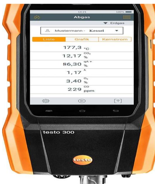
Рис. 5.42. Фотографія аналізатора TESTO 300 з показниками параметрів парогенератора: температури димових газів (177 °С); вмістом CO (12 %); ККД (86,3 %); \alpha (1,17); \text{O}_2 (3,4 %); CO (229 ppm)
