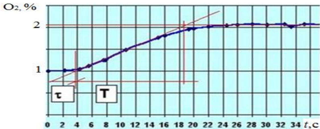
Рис. 2.28. Експериментальна розгінна крива вмісту O_2 в димових газах парового котла ДКВР 8 (парове навантаження 0,5 від номінального) при стрибкоподібній змінні витрати повітря ( \Delta N = 10 \text{ м}^3/\text{с} )
