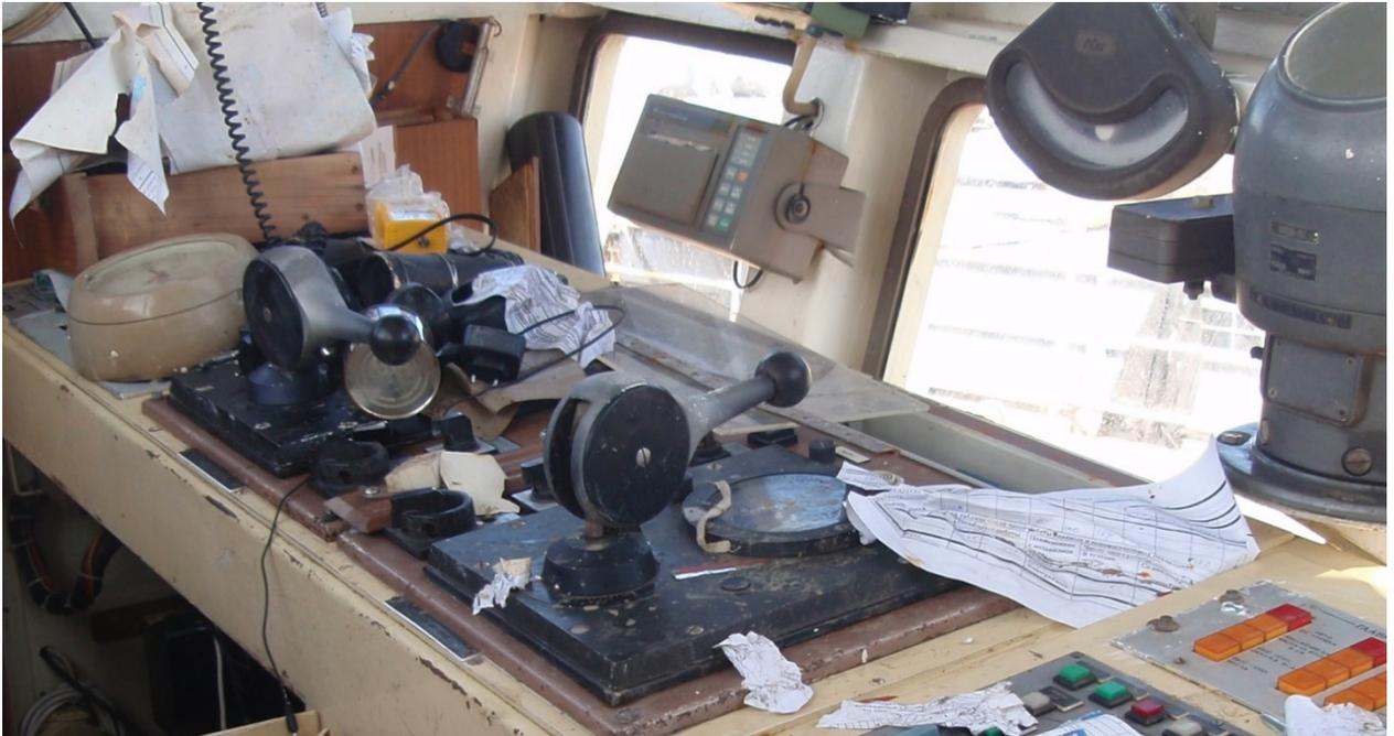
Рис. 3.2 – Положение ручек ВРК перед затоплением буксира-толкача.
