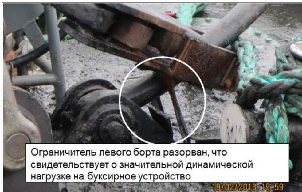
Рис. 3.12. Положение ограничителя буксирной дуги.
