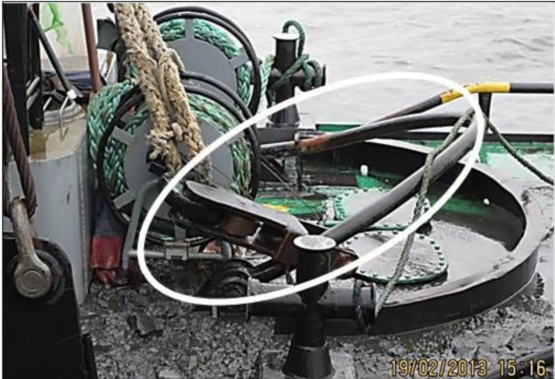
Рис.3.11. Буксирный гак и буксирный трос на левом борту, деформированная буксирная дуга.
