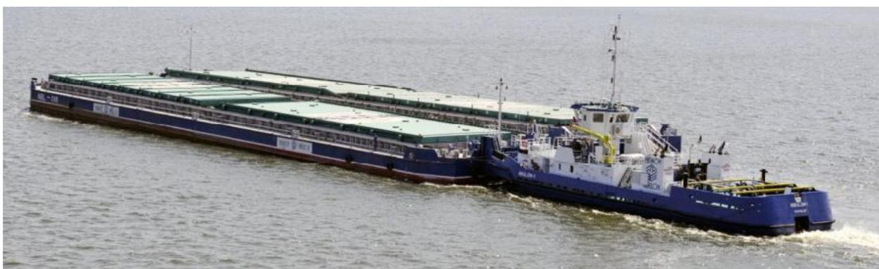
Рис. 1.8 – Режим толкания жестко соединенных судов (барж) буксирами-толкачами
