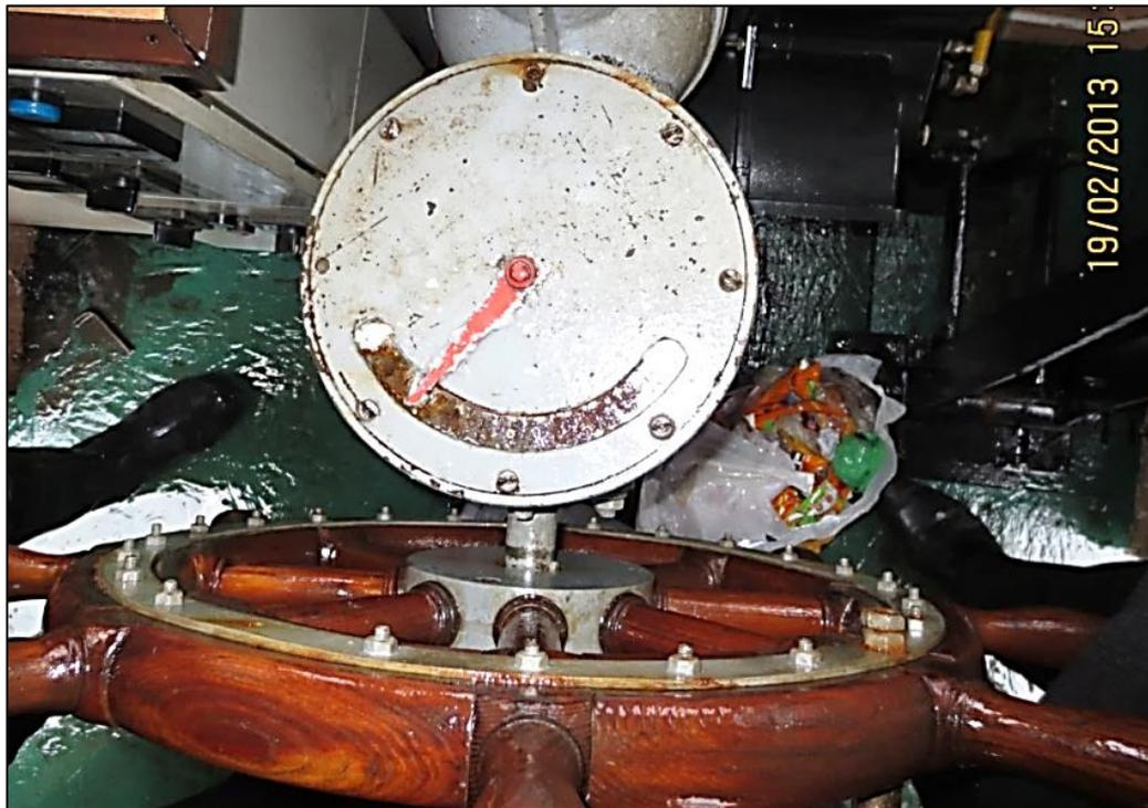
Рис. 3.10 Положение руля зафиксированное на аксиометре - «лево на борт».
