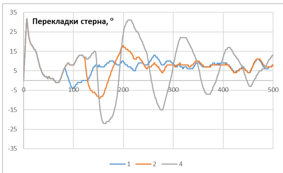
Рис. 4.21. Перекладки стерна. Утримання судна на траєкторії, модель – контейнеровоз S-175, швидкість – 10 вузлів
