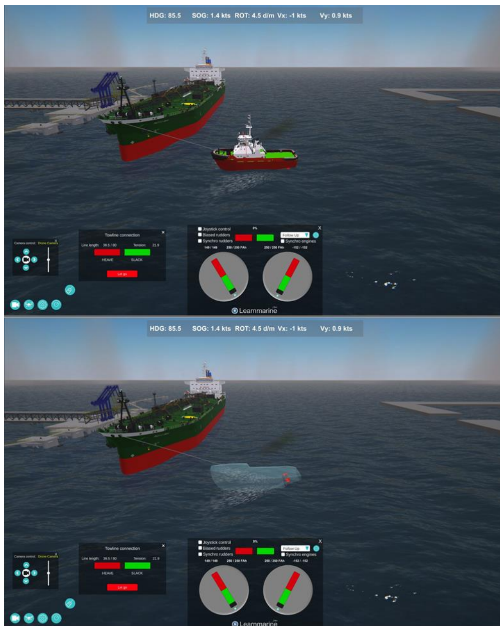
Рис. 4.5. Реалізація методу розрахунку остійності у реальному часі на програмному забезпеченні ASD Tug Simulator.
