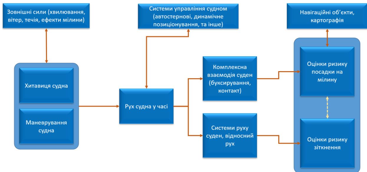
Рисунок 6 - Схема моделювання руху судна при розв'язанні навігаційних задач
