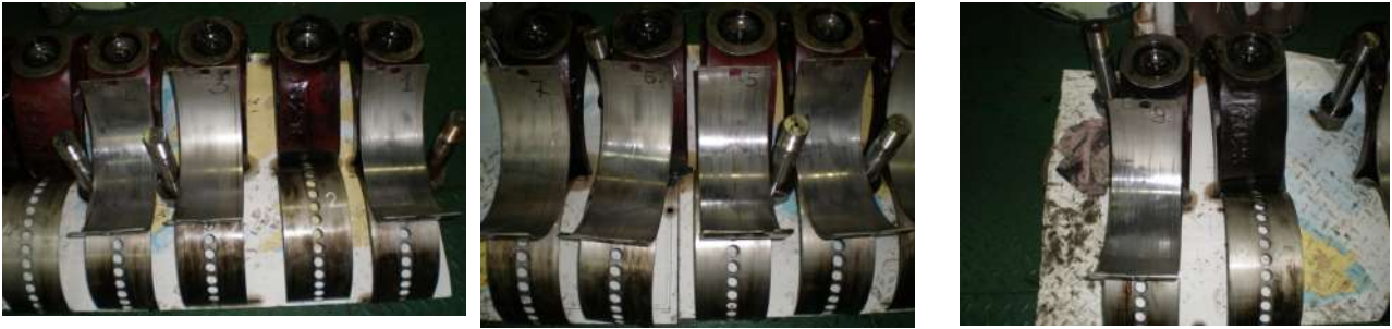
Рис. 7. Стан вкладишів підшипників дизеля 9М43С фірми МаК, що експлуатується на моторному мастилі MOBIL Mobilgarg412 (параметр порядку ГЗШ S=0,42...0,46 , товщина ГЗШ d_s=12,3...12,5 мкм, реологічна стійкість v=9,3 %)
