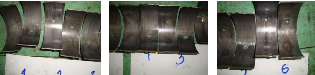
Рис. 8. Стан вкладишів підшипників дизеля 9М43С фірми МаК, що експлуатується на моторному мастилі BP ENERGOL DS 3-154 (параметр порядку ГЗШ S=0,36...0,39 , товщина ГЗШ d_s=10,3...10,5 мкм, реологічна стійкість v=7,5 %)
