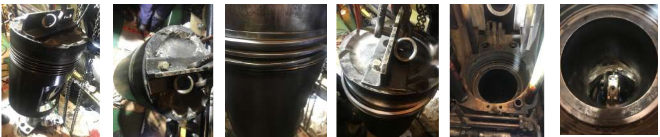
Рис. 13. Технологія монтажних робіт під час визначення зносу поршневих кілець судового дизеля 12V32/40 MAN-B&W
