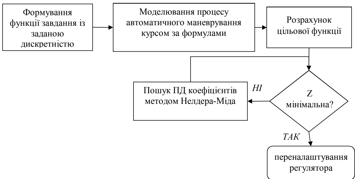
Рис. 3. Блок-схема алгоритму налаштування ПД регулятора
