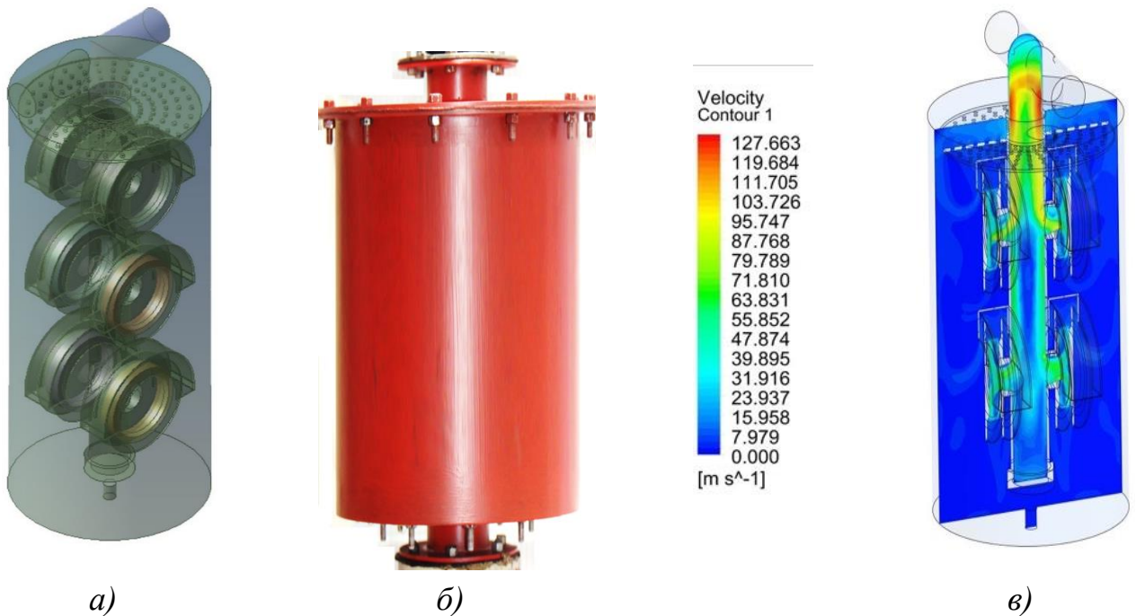
Рисунок 5 – Сепаратор стиснутих газів енергосистем: а) тривимірна модель; б) фото сепаратора; в) розрахунок швидкості
