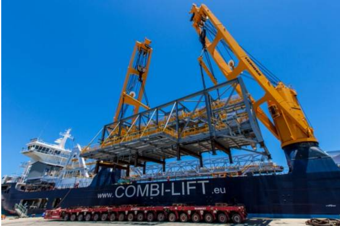
Рисунок 1.3 – Палубні стрілові крани з гнучким підвісом стріли
