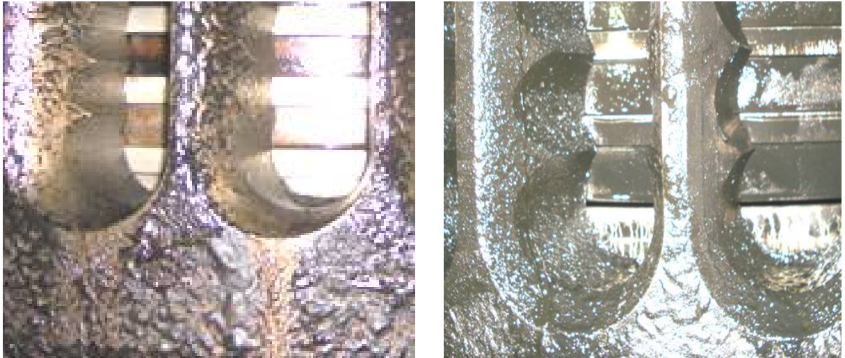
Рис.5.21. Нагари на деталях ЦПГ № 3 (експериментальний) і № 7 (базовий)
