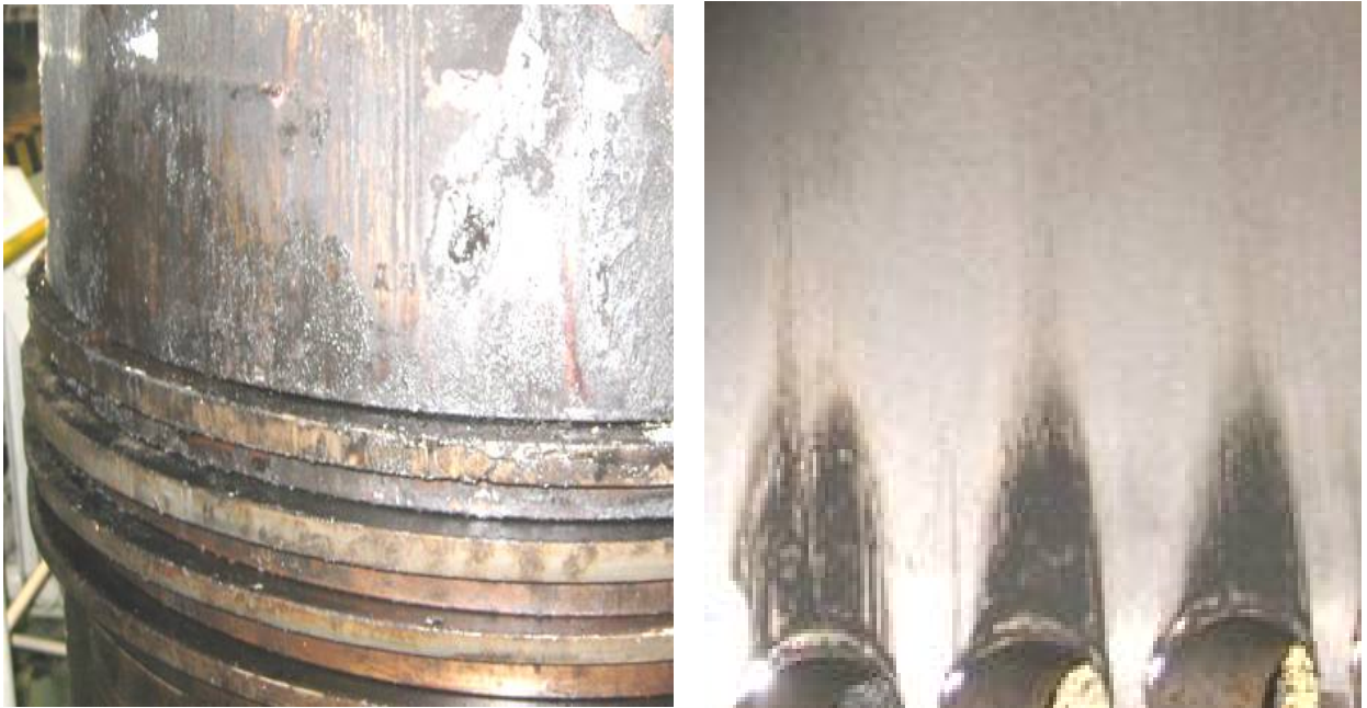
Рис.5.18. Стан деталей ЦПГ № 1 (базовий) наприкінці випробувань
