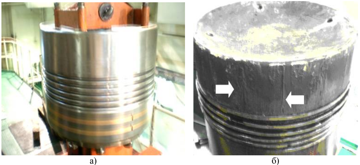
Рис.3.5. Стан головки поршня: до установки на двигун (а) і після розкриття (б)
