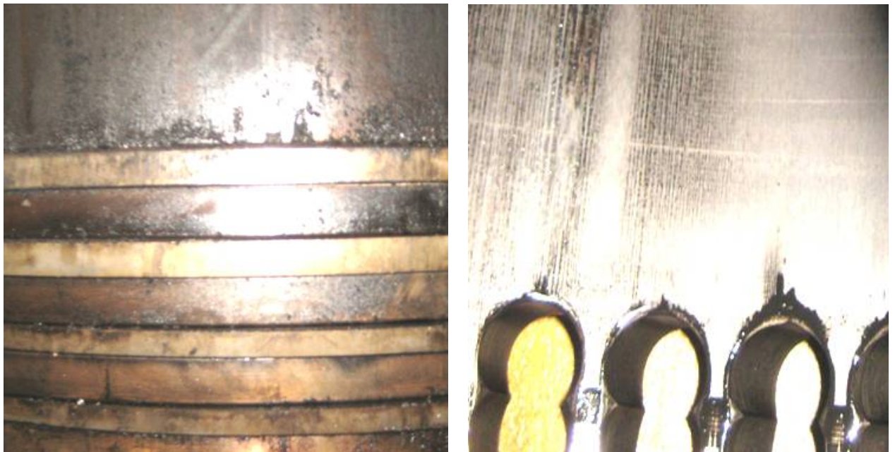
Рис.5.17. Стан деталей ЦПГ № 3 (експериментальний) наприкінці випробувань
