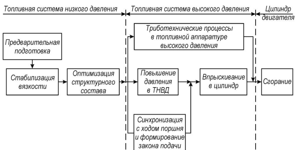
Рис. 5.3. Последовательность протекания технологических процессов в топливной системе судового СОД
