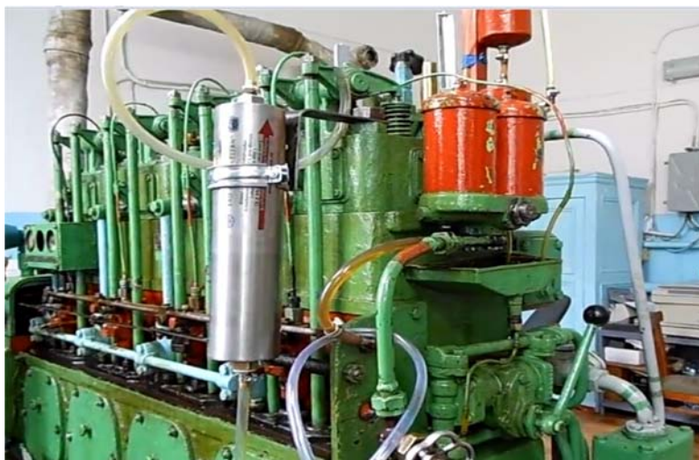
Рис. 5.8. Лабораторный стенд - дизель-генератор 4DV – 224 мощностью 100 л.с.
