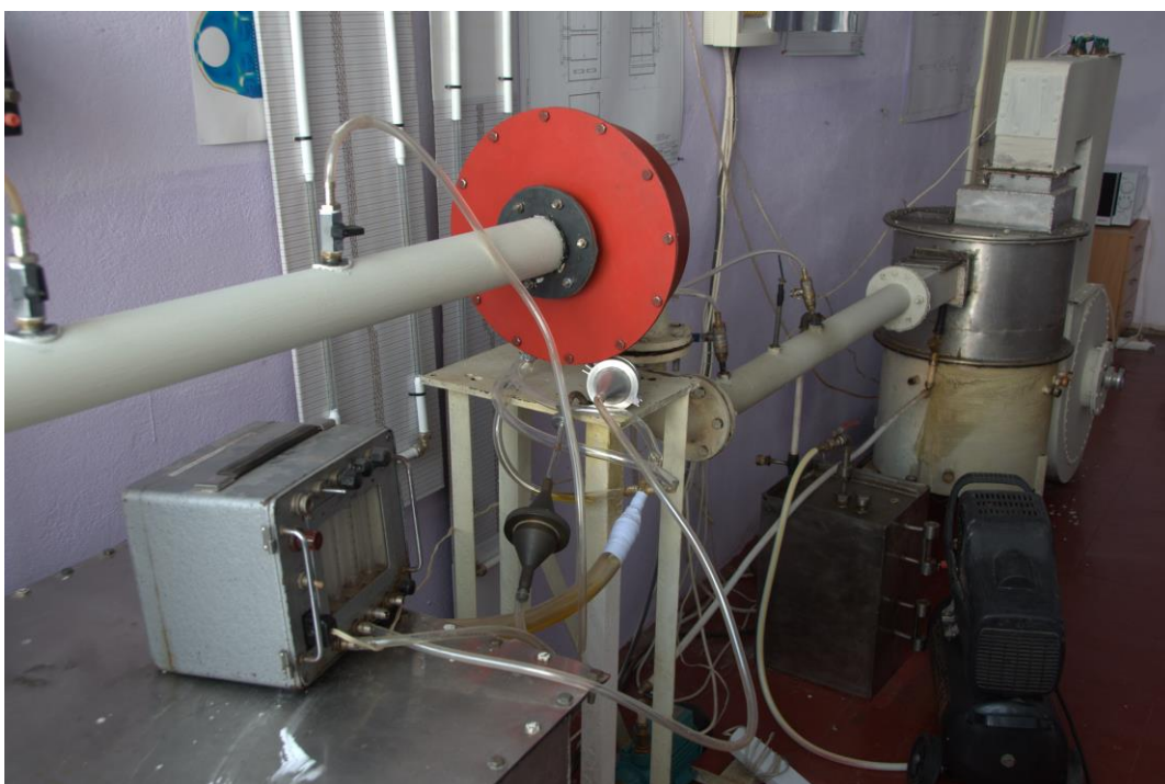
Рисунок 5.4 – Розміщення дослідного зразку турбоімпактного сепаратора паливного газу на експериментальному стенді
