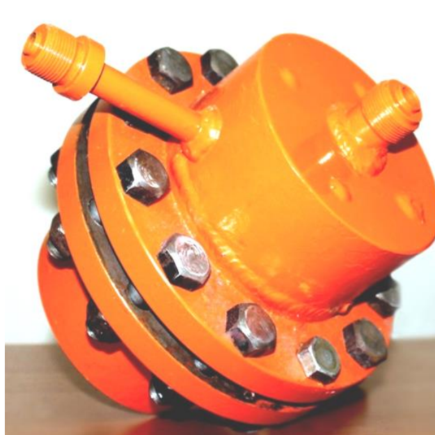
Рисунок 5.8 – Фотографія дослідного зразку турбоімпактного масловіддільника стиснутих газів системи суфлювання ГТУ замкнутого циклу
