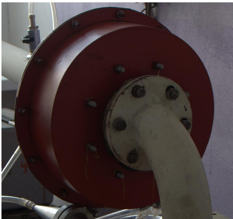
Рисунок 5.3 – Фотографії дослідного зразку турбоімпактного сепаратора паливного газу для ГТУ
