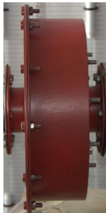
Рисунок 5.3 – Фотографії дослідного зразку турбоімпактного сепаратора паливного газу для ГТУ
