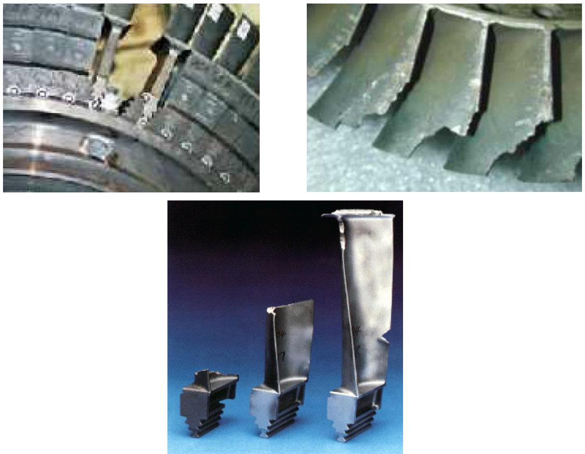
Рисунок 1.1 – Дефекти лопаткових апаратів при попаданні конденсату в проточну частину
