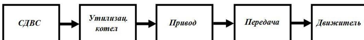
Рис. 1.7. Четвертый технологический контур
