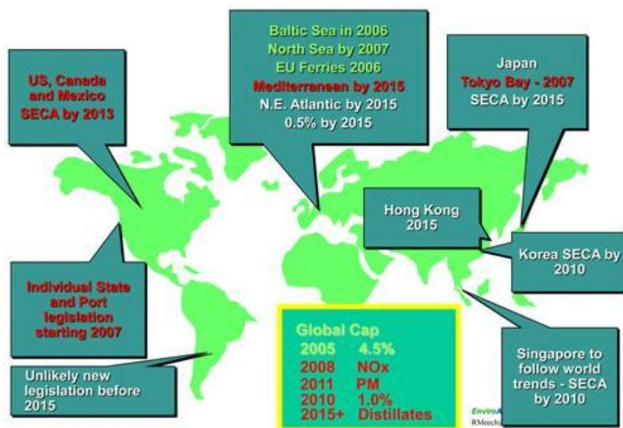
Рис. 1.1. Сводная характеристика районов контроля судовых газообразных выбросов
