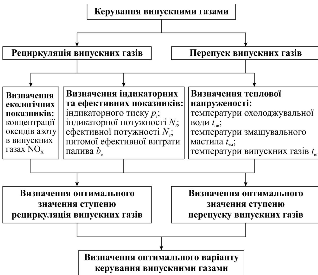
Рис. 2.4. Блок-схема проведення експериментальних досліджень під час визначення оптимального варіанту керування випускними газами
