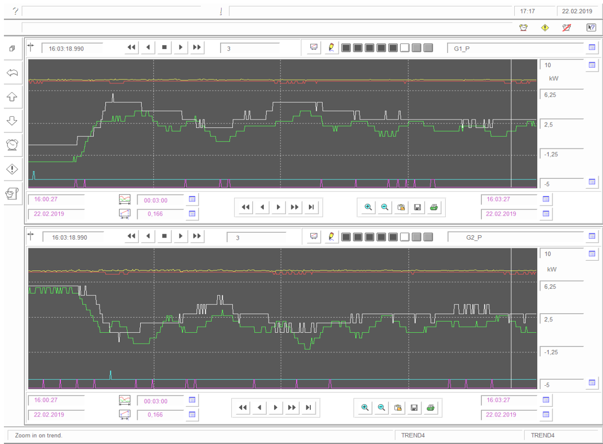
Рис. 18. Відображення на екрані головного комп'ютера експериментальних процесів синхронізації ГА (SCADA Expert Vijeo Citect V7.40)
