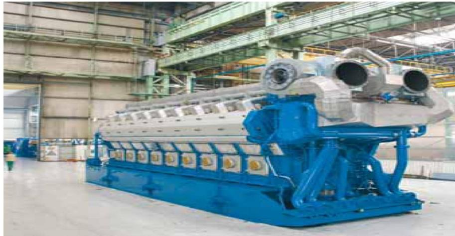
Рис.8 Двухтопливный двигатель 50DF фирмы Wartsila Corp.
