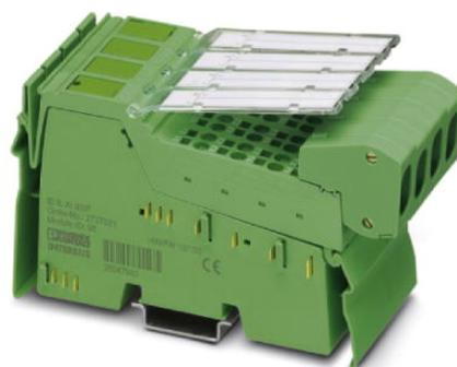
Рис. 1. Модуль USO IB IL AI 8/SF-PAC
