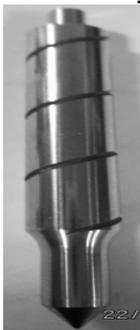
Рис .3 Игла распылителя форсунки дизеля RT- Flex
