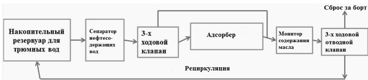
Рис.1. Установка очистки нефтесодержащих (ляльных) вод
