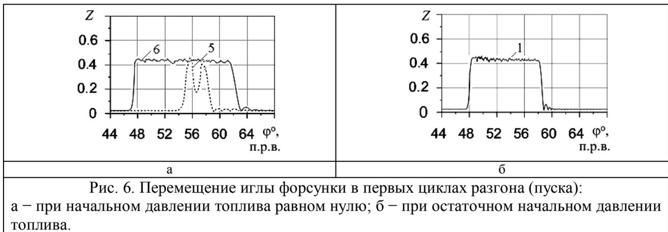
Действительно, пятый цикл разгона первого эксперимента (рис.6а) является ступенчатым. При этом продолжительность впрыскивания значительно меньше, чем в последующем шестом цикле, а начало смещено по углу поворота в сторону запаздывания.
