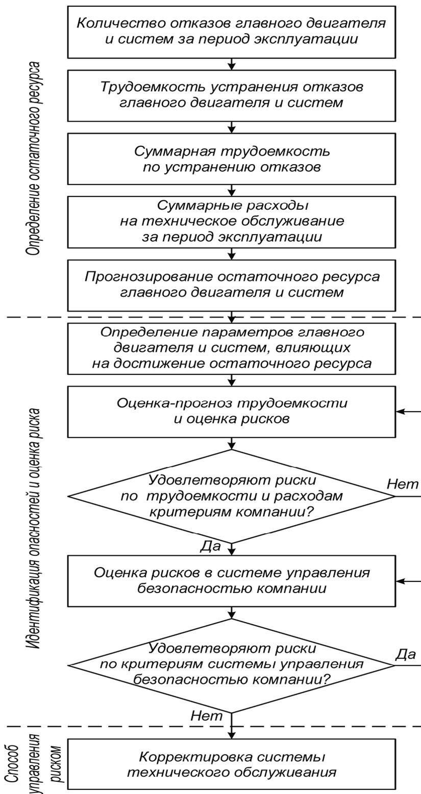
Рис.3. Принципиальная схема управления риском в системе ТО для СЭУ с остаточным ресурсом
