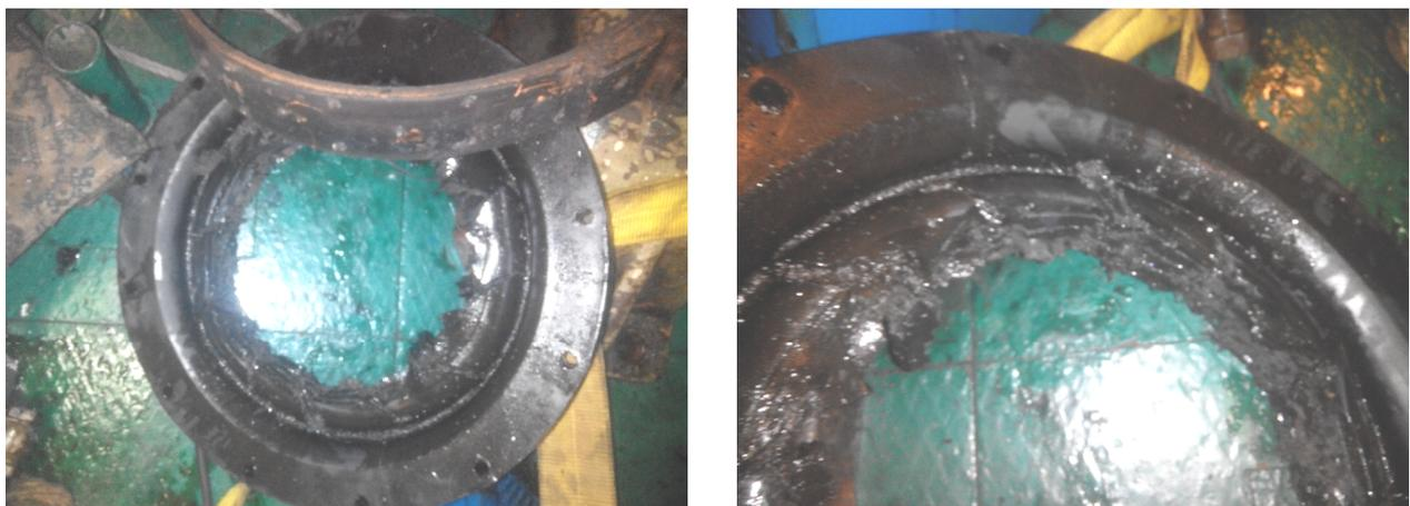
Рис. 2. Зруйнований пружний елемент базової муфти
