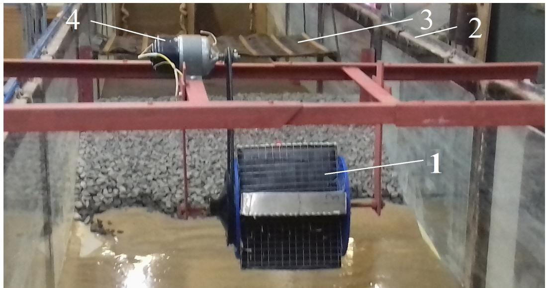
Рис.4. Экспериментальная модель волнового генератора в гидродинамическом лотке.
