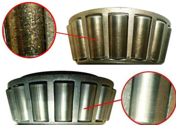
Мал. 3. Зношування підшипників кочення: вгорі підшипник після 1000 годин експлуатації, внизу з використанням нанопорошку  $Al_2O_3$  після 6000 годин експлуатації
