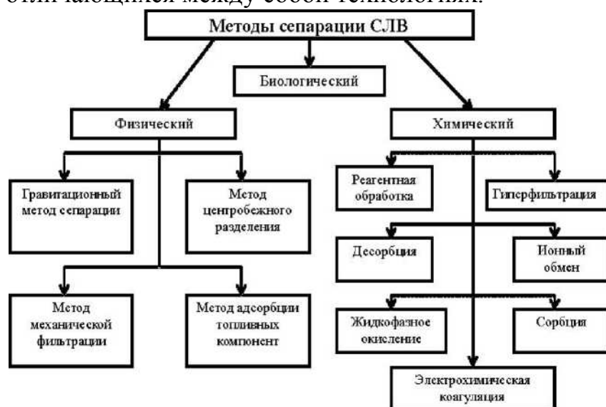
Рис. 1. Методы сепарации судовых льяльных вод
