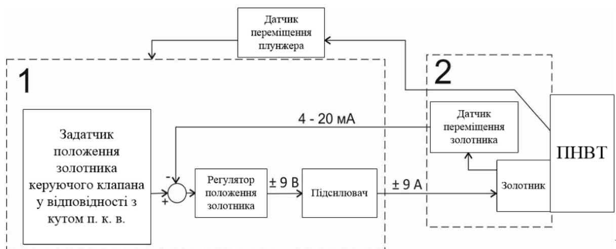
Рисунок 1.3 – Система управління пропорційним швидкодіючим клапаном: 1 - блок управління циліндром, 2 - пропорційний клапан, ТНВД - паливний насос високого тиску
