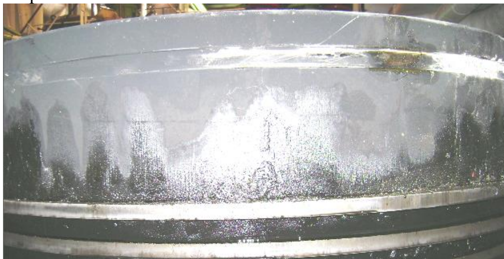
Рис.2 Сліди зустрічі масла з поверхнею головки поршня
