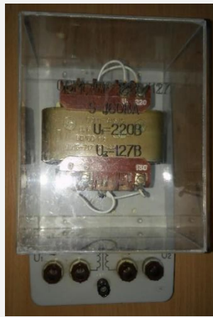
Рис. 4 – Комплект настільних блоків: селісини (а), однофазний трансформатор (б), котушка індуктивності з магнітопроводом (в, г)
