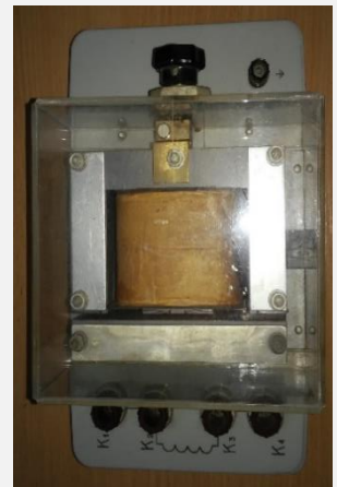
Рис. 4 – Комплект настільних блоків: селісини (а), однофазний трансформатор (б), котушка індуктивності з магнітопроводом (в, г)
