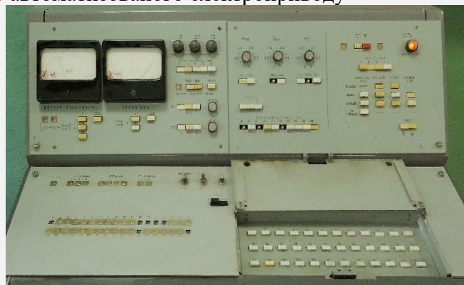
Рис.2 – Лабораторний стенд для дослідження безконтактних електроприводів з панелями введення несправностей
