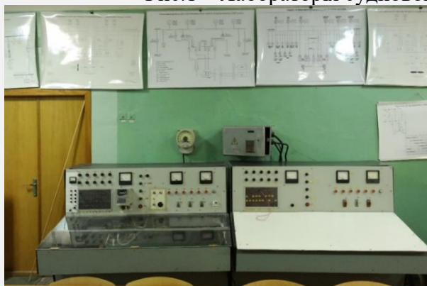
Рис.2 – Лабораторний стенд для дослідження безконтактних електроприводів з панелями введення несправностей
