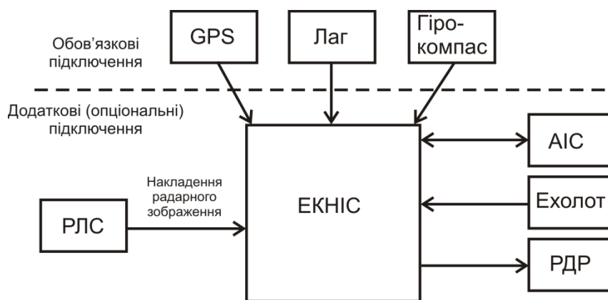
Рисунок 2.7 – Обов'язкові та додаткові (опціональні) підключення приладів до ЕКНІС
