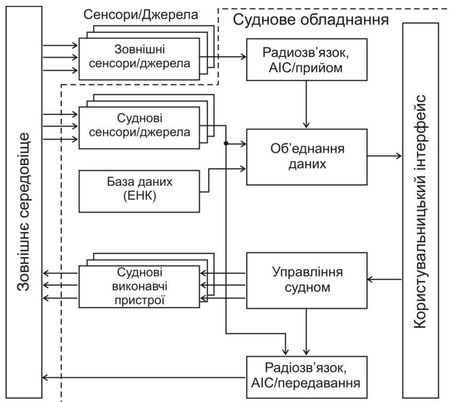
Рисунок 2.2 – Перетворення інформації в системах навігації і радіозв'язку в рамках парадигми об'єднання даних і управління судном
