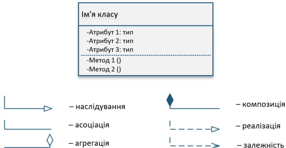
Рис. 4.6 – Приклад блоку UML-діаграми класів з позначеннями відношень
