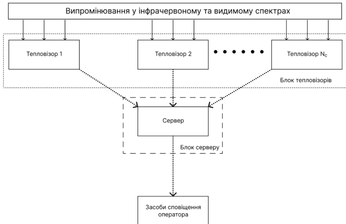
Рис. 4.2 – Загальна схема моделі суднової системи спостереження за температурним станом вантажів з використанням тепловізорів
