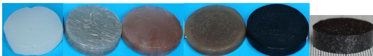
Рисунок 1 – Загальний вигляд зразків термоакумулювальних матеріалів (в порядку зліва направо): парафін без добавок, парафін з вмістом алюмінієвого волокна, мідного волокна, фулерену, вуглецевих нанотрубок, терморозширеного графіту
