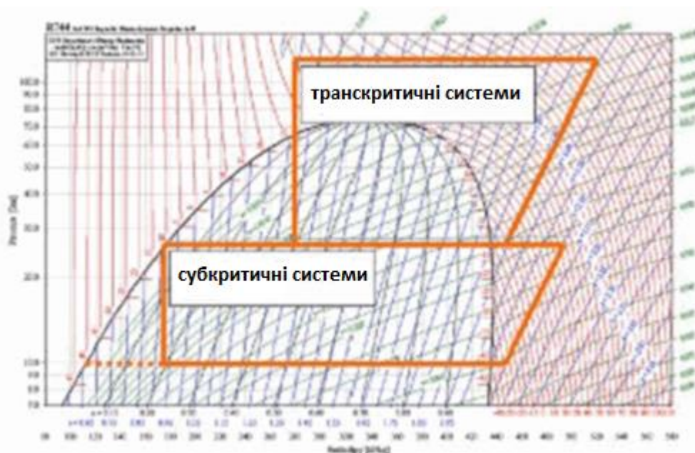
Рисунок. 1 – Діаграма тиск - ентальпія для холодильного агенту R744
