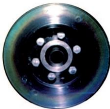
Рис. 1 Перегрів демпфера внаслідок розвитку крутильних коливань
