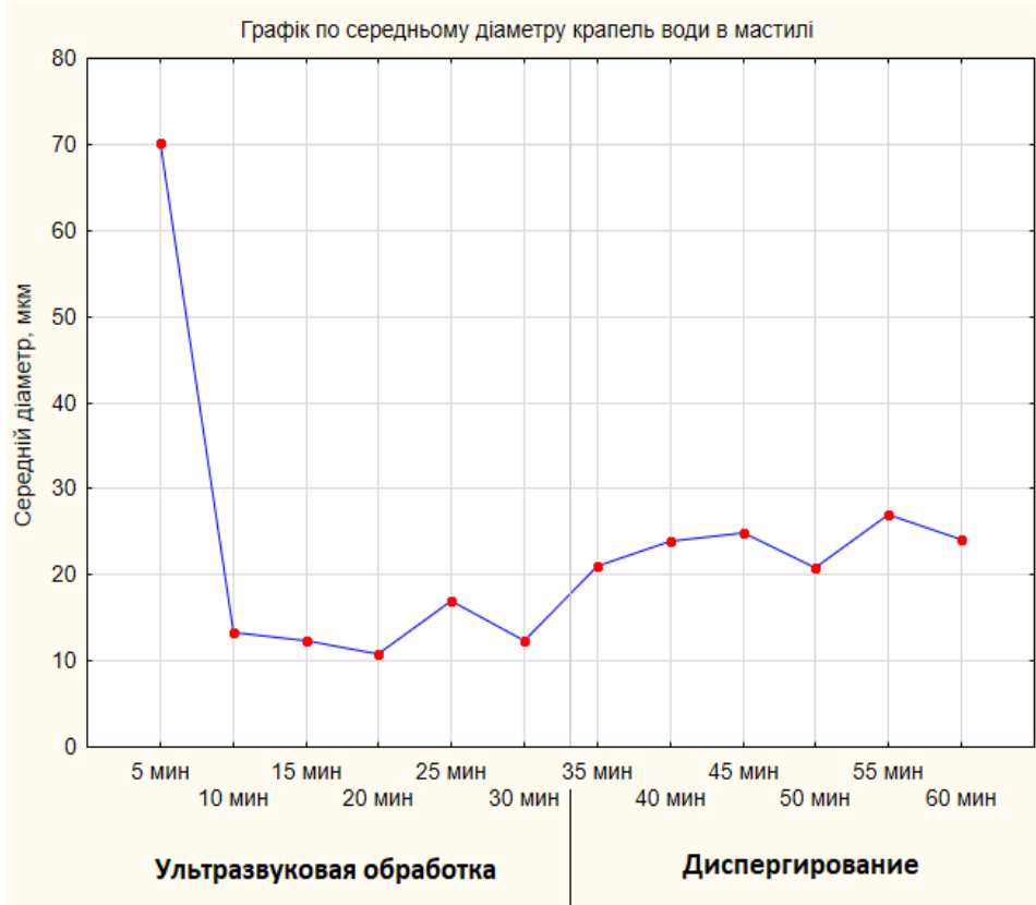
Рис. 1. Середній діаметр крапель ВМЕ залежно від часу та виду обробки
