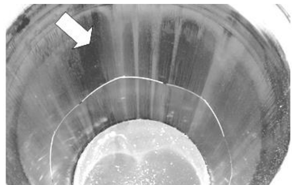
Рис. 2 Натирання на дзеркалі втулки
