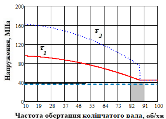
Рисунок 1 - Вектори коливальних станів для двох форм коливань та напруження на найбільш напружених ділянках валопроводу
