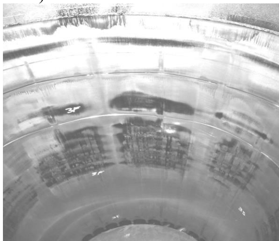
Рис. 3. Натирання на поверхні зеркала втулки (а) і нагари на поршні (б)
