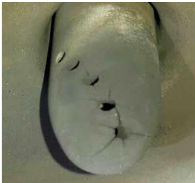
Рисунок 1 – Тріщини в оголовку клапана GIV [3]
