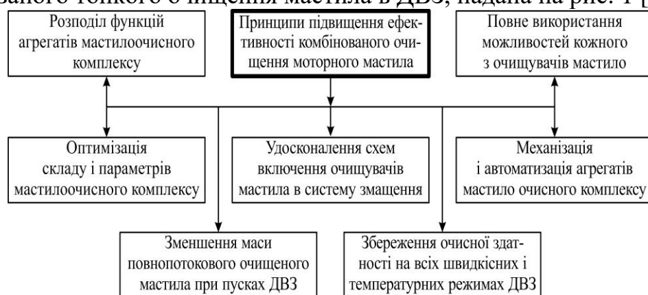
Рис. 1. Принципи підвищення ефективності комбінованого тонкого очищення мастила в ДВЗ
