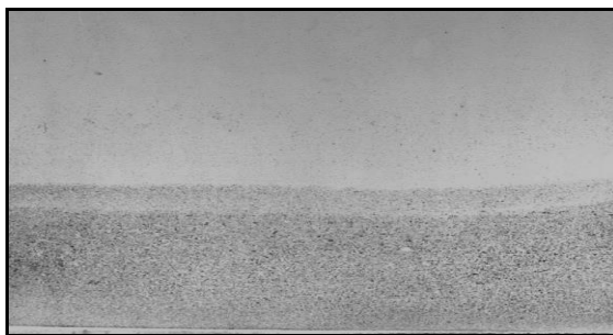
Рис. 1. Макрошлиф основного металу та дифузійного прошарку сталі з часткою хрому 12%.
