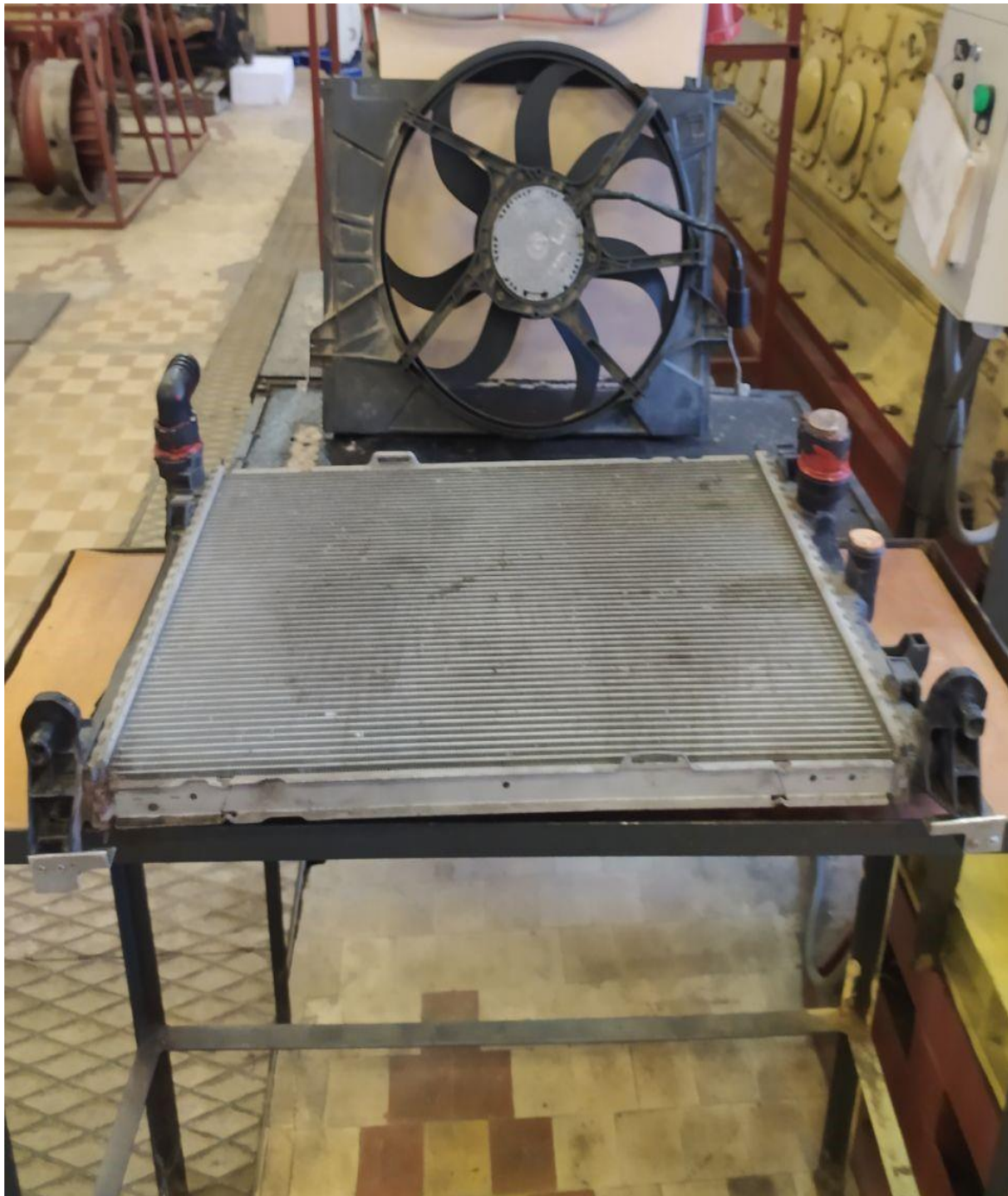
Рисунок 3 – Зовнішній вигляд додаткового радіатора з вентилятором ЗАКЛЮЧЕННЯ
