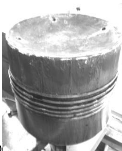
Рис. 3. Натирання на поверхні зеркала втулки (а) і нагари на поршні (б)
