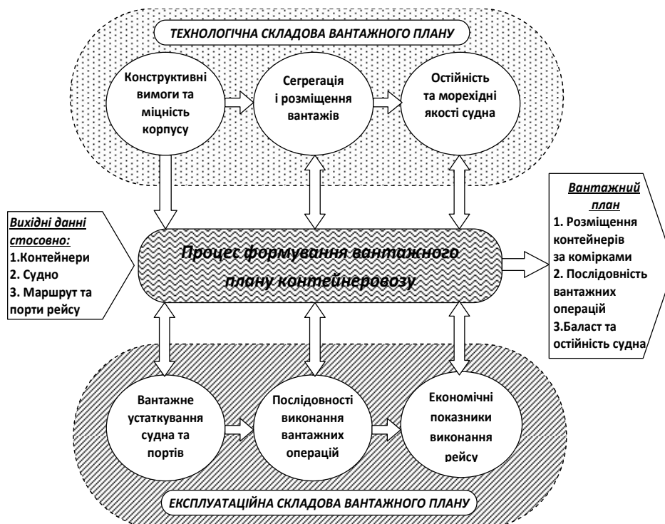
Рисунок 3.8 – Структура процесу формування вантажного плану контейнеровозу [157]
