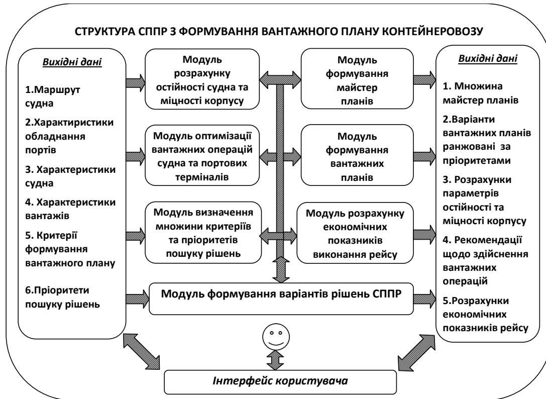
Рисунок 3.9 – Структура СППР з формування вантажного плану контейнеровозу для мультипортових контейнерних перевезень [157]
