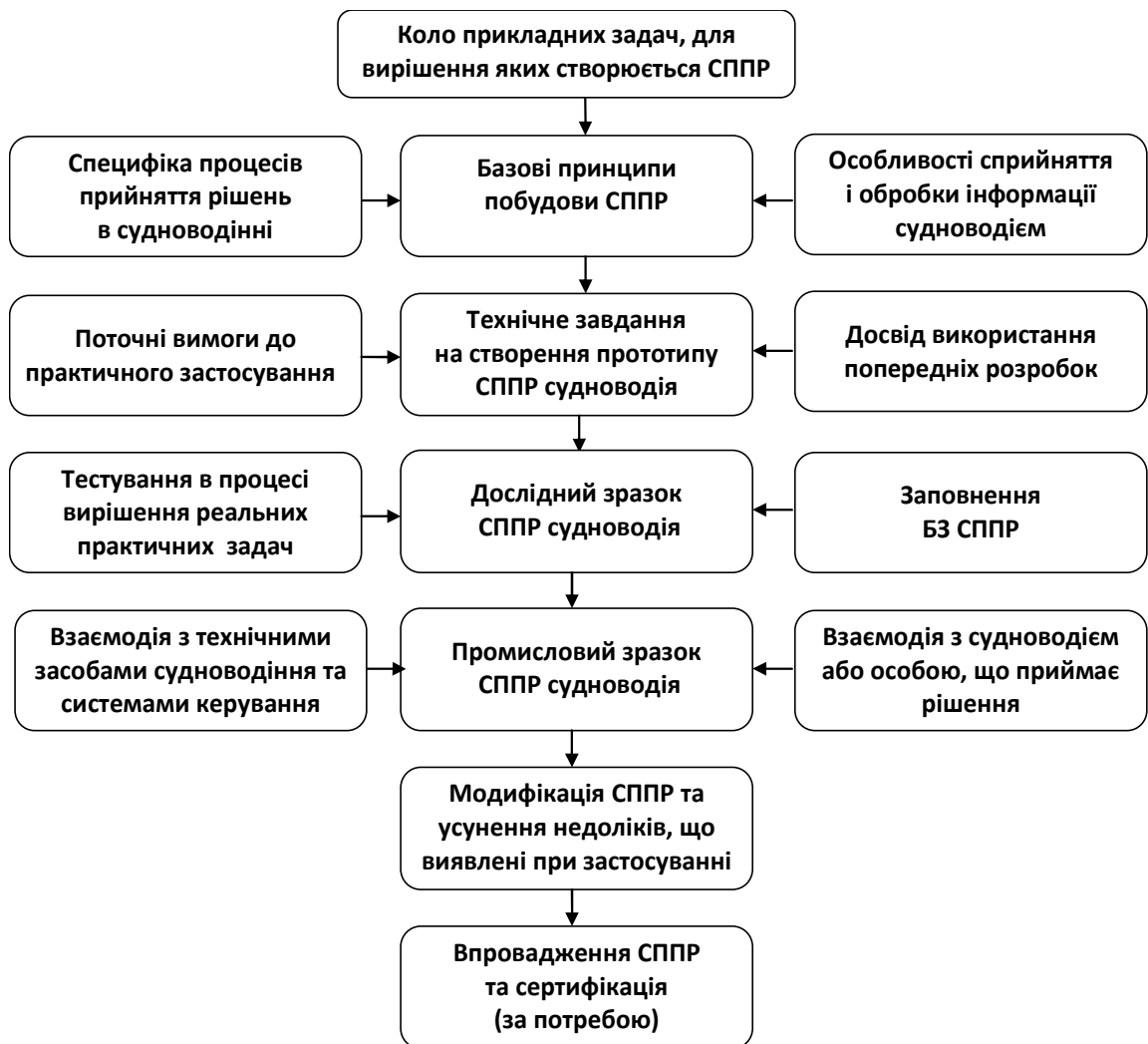
Рисунок 1.2 – Життєвий цикл створення СППР в судноводінні
