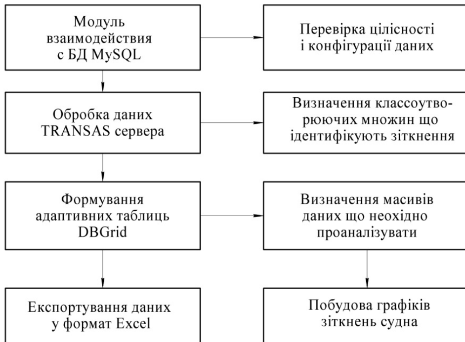
Рисунок 5.7 – Алгоритм конвертації і аналізу даних сервера NTPRO 5000 [73,222]
