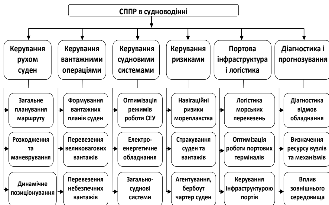
Рисунок 1. Класифікація напрямків застосування СППР в галузі судноводіння
