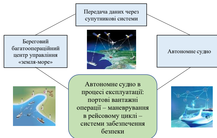
Рис. 2. Компоненти дистанційного управління автономним судном (автор: Шумілова К.В.)
