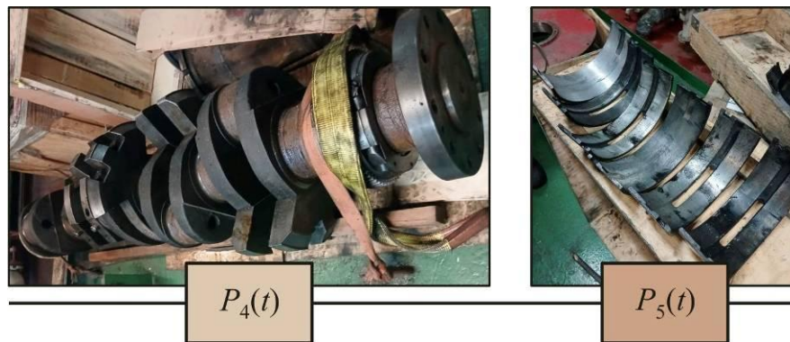
Рис. 1.7. Елементи системи колінчатий вал – вкладиш підшипника (фото отримані під час інспекції дизеля 6DE-18 Daihatsu Diesel)
