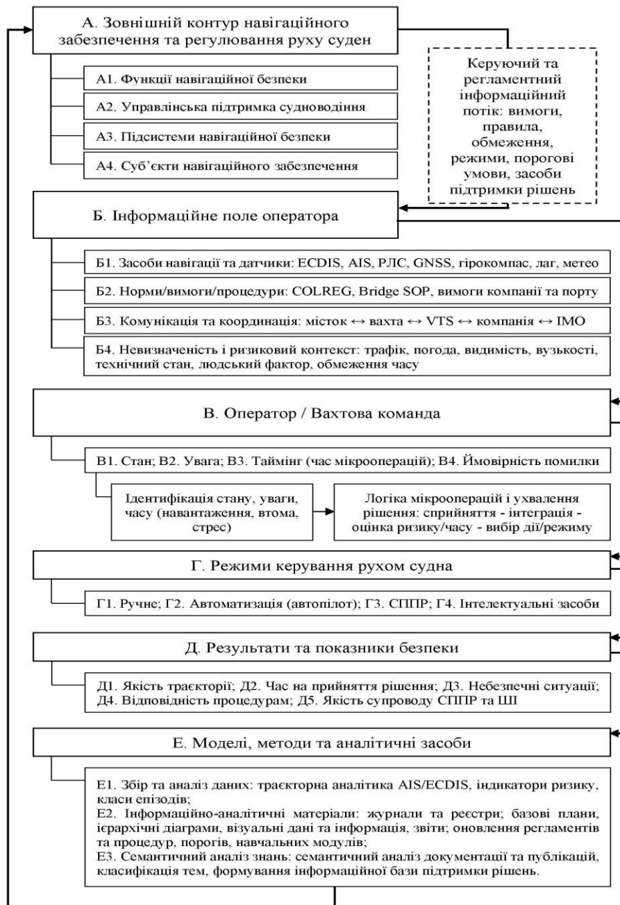
Рисунок 3. Концептуально-структурна модель інформаційного поля оператора в ергатичній системі навігаційного забезпечення
