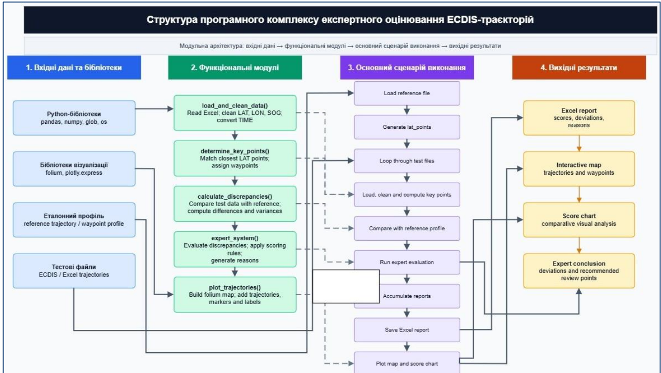
Рисунок 20. Структура автоматизованої експертної системи оцінювання ECDIS-відхилень траєкторії руху судна
