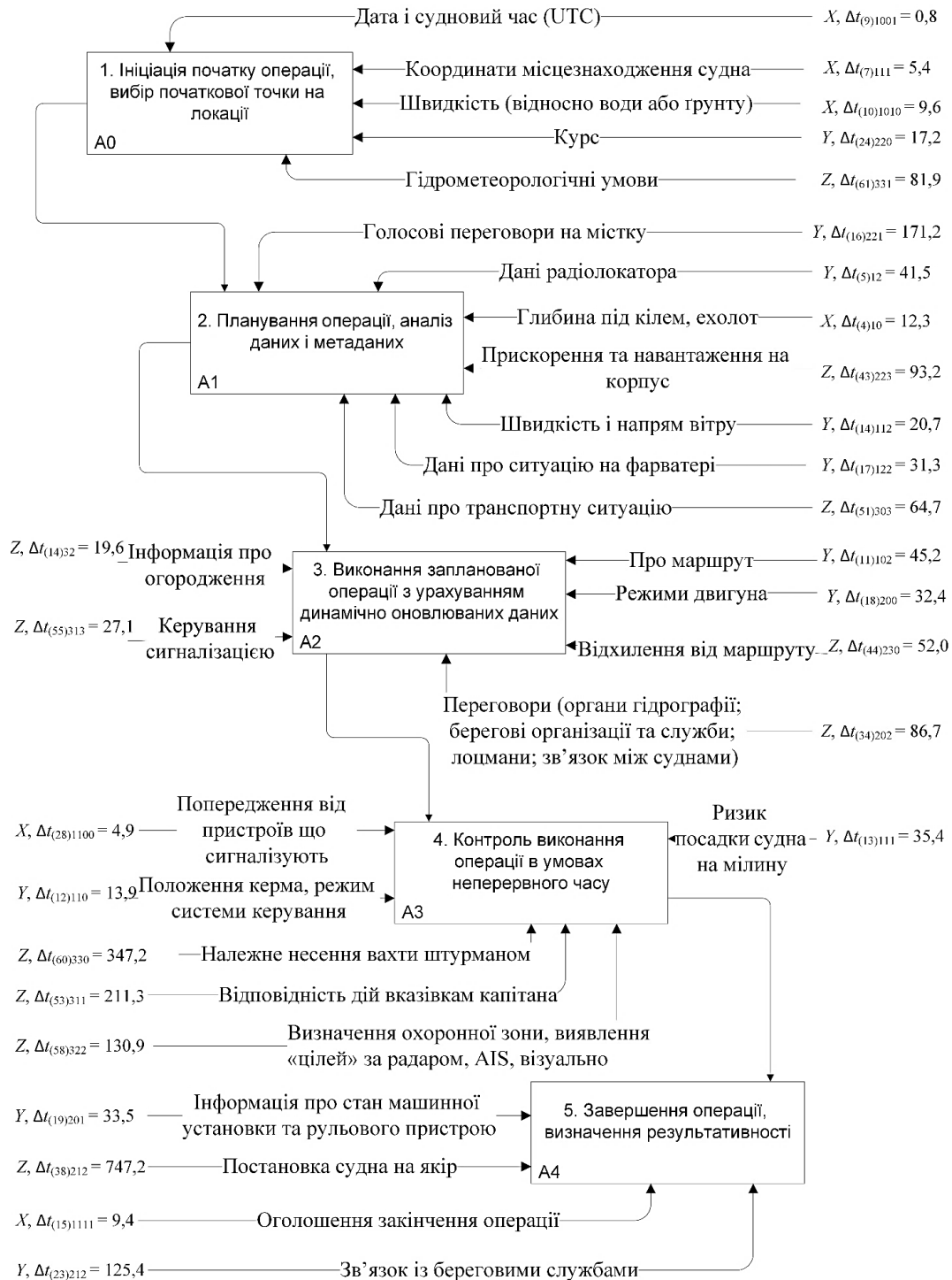
Рисунок 21. Аналіз операцій відносно X_{(p=2)} , Y_{(p=3)} , Z_{(p=4)} і часу виконання
